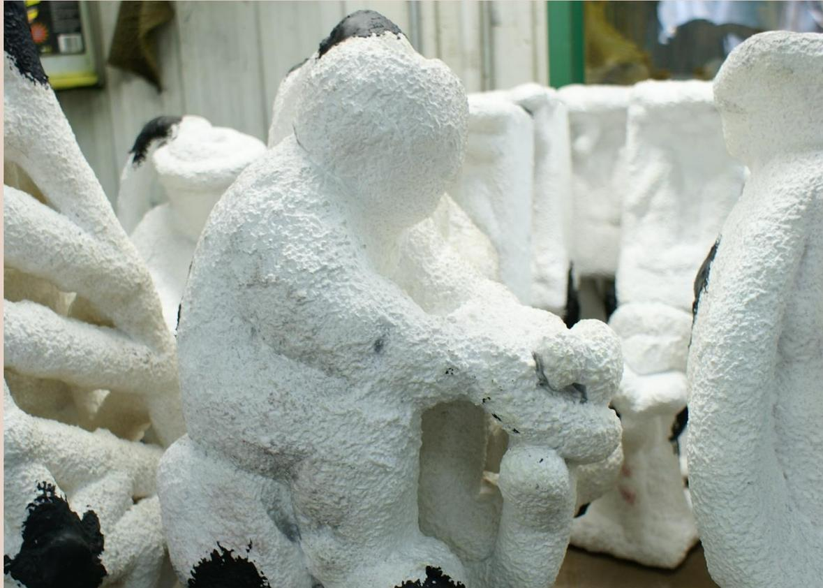
On doit maintenant cuire la coquille et faire sortir la cire qui est à l'intérieur. On ouvre donc le couvercle de la tasse de céramique pour permettre à la cire de s'écouler. La coquille est placée dans un four et chauffée à 750 degrés Celsius. Quand la coquille est cuite, elle devient blanche.
